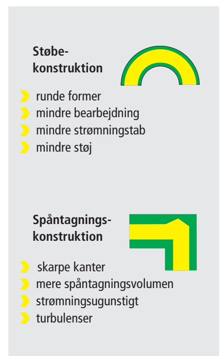
Fig. 3: Sammenligning støbekonstruktion og spåntagningskonstruktion
