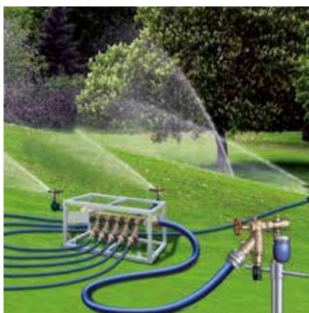
Tilslutning af et sprinklersystem i offentlige parker. Anvendelse iht. DIN 1988, del 100, tabel A1, anvendelsestilfælde nr. 7.
