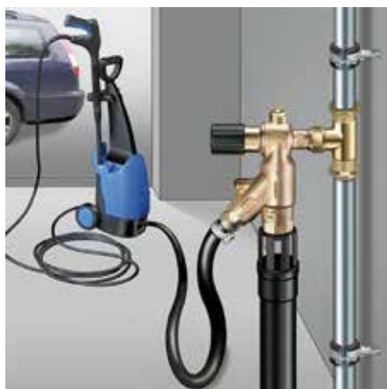
Tilslutning af en højtryksrenser med/uden tilsætning af kemikalier med KEMPER FK-4. Anvendelse iht. DIN 1988, del 100, tabel A1, anvendelsestilfælde nr. 33.
