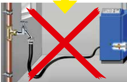
Ikke godkendt Påfyldning efter fjernelse af påfyldningsanordningen
