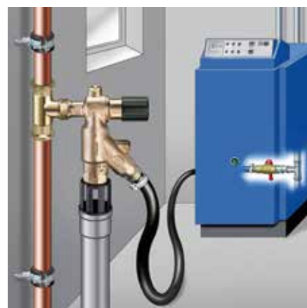
Påfyldning af varmeanlæg med inhibitorer med KEMPER FK-4. Anvendelse iht. DIN 1988, del 100, tabel A1, anvendelsestilfælde nr. 32.
