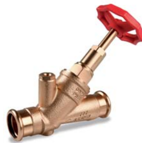
WESER-fristrømsstopventil med fast prestislutning system Geberit MAPRESS til rør i rustfrit stål og kobber, med tømmeprop figur 190 22
